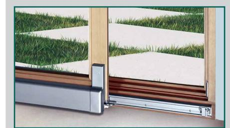
KOCH PSK Elemente sind standardmäßig mit einer Zwangssteuerung ausgestattet, die den Flügel beim Schließen auf ganzen Breite anzieht und gleichmäßig an den Rahmen drückt und beim Öffnen wieder in die Kippstellung bringt. Eine komfortable, flache Bodenschwelle ist auf Wunsch bzw. nach einer technischen Klärung möglich.
