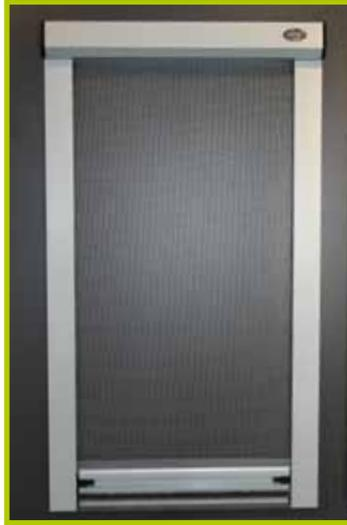
Rolo-Insektenschutz-Rollo besteht aus stabilen Aluprofilen, filigraner Kassette, Bürstenführungen, integrierter Bremse und einer Simplex-Verriegelung.
