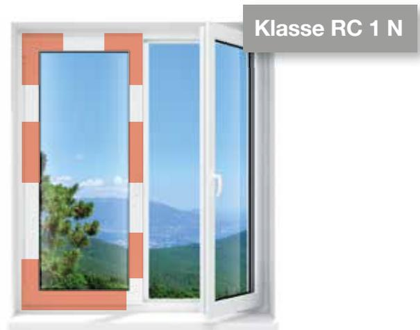
Diese Widerstandsklasse ist empfehlenswert als Grund-sicherung für Fenster in oberen Geschossen und wird lediglich mit Standardfensterglas ausgeführt. Sechs Sicherheitsschließteile werden umlaufend gesetzt (bei einer Elementhöhe unter 1400 mm werden vier Schließstücke verbaut), so dass das Fenster an allen Seiten gegen körperliche Gewalt ohne den Einsatz von Werkzeugen gesichert ist. Zusätzlich muss ein abschließbarer Fenstergriff mit einem geprüften Drehmoment von 100 Nm verbaut werden.
